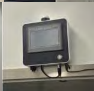
固定式辐射监测仪报警仪（3 探头设在废物间西侧墙外楼道、PET/CT 控制室内、污染检测室门口）
