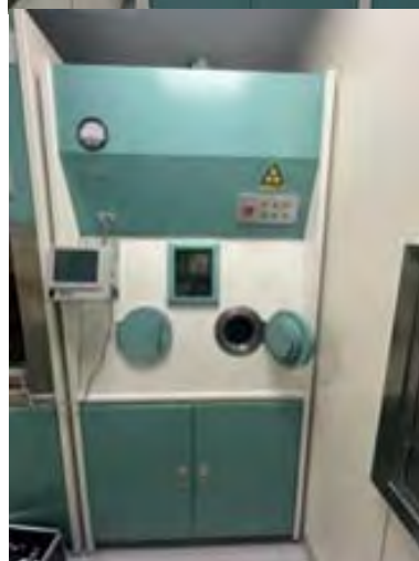
放化实验室配备的 3 个热室（正面 \geq 60\text{mmPb} 铅当量，其余五面屏蔽 \geq 50\text{mmPb} ）
