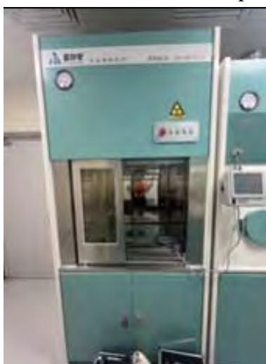
放化实验室配备的 35\text{mmPb} 防护通风橱
